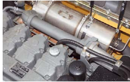
Abb. 2: Partikelfilter im Motorraum – keine Sichtbehinderung
