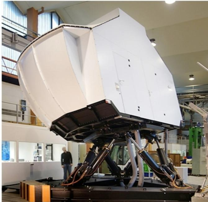
Abb. 1 Interaktiver Forschungs- und Entwicklungssimulator für Bau- und mobile Arbeitsmaschinen am Lehrstuhl für Baumaschinen und Fördertechnik der TU Dresden (Prof. Kunze)
