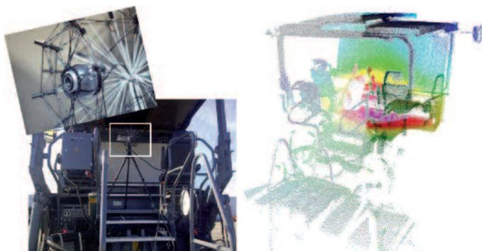
**Bild 6: Messungen der Geräuschimmission im Bereich des Fahrerkopfes mit einer akustischen Kamera, Immissionsplot zur Schallquellenlokalisierung**
